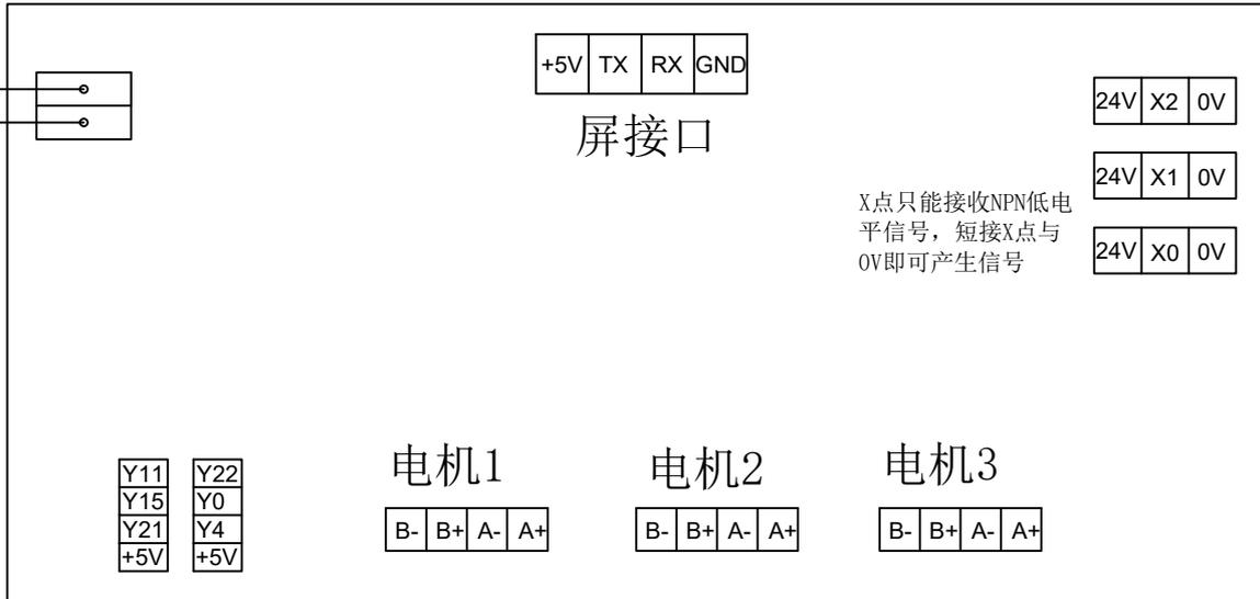
X点只能接收NPN低电平信号，短接X点与0V即可产生信号
